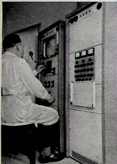
Bild 3. Im Technischen Kontrollraum befinden sich der Kamera-Verstärkerschrank (links) und der Kamera-Kontrollschrank (rechts)
